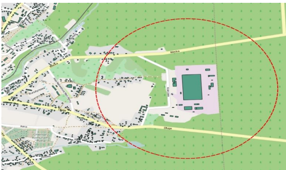
Rysunek 2. Wizualizacja zasięgu oddziaływania amoniaku (wg parametru NDS) przy najbardziej niekorzystnym scenariuszu awarii przemysłowej (zakłady mięsne Animex SA – oddział Starachowice). Strefę wyznaczono przy pomocy programu Aloha.
